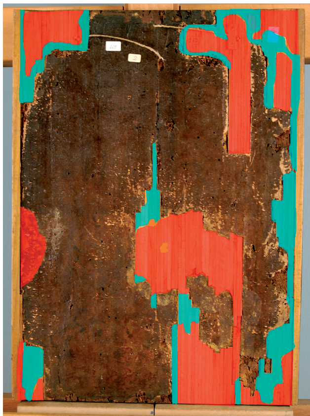
Εικ. 14. Σχηματική απεικόνιση των παλαιότερων επεμβάσεων. Μπλε χρώμα: πολυουρεθάνη, κόκκινο: εποξειδική ρητίνη, κίτρινο: λευκό του τσίγκου.
