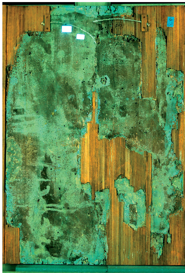
Εικ. 10. Φθορισμός της πίσω όψης με διέγερση υπεριώδους ακτινοβολίας.
