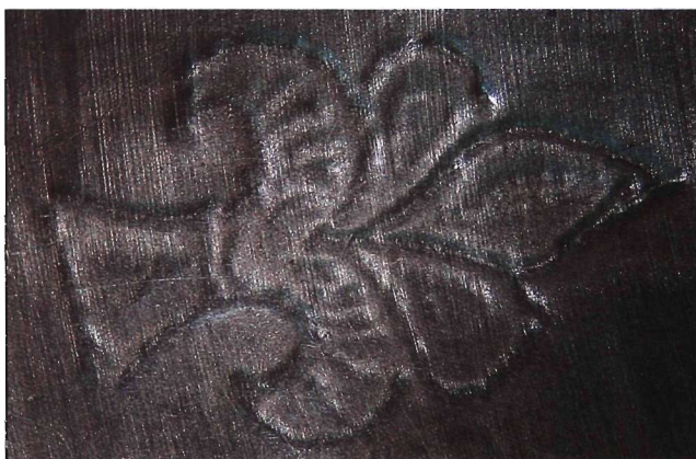
Εικ. 1. Αποτύπωμα εφαρμογής του μηχανήματος στο κέντρο της βάσης των δίσκων (στο εσωτερικό 40x).
