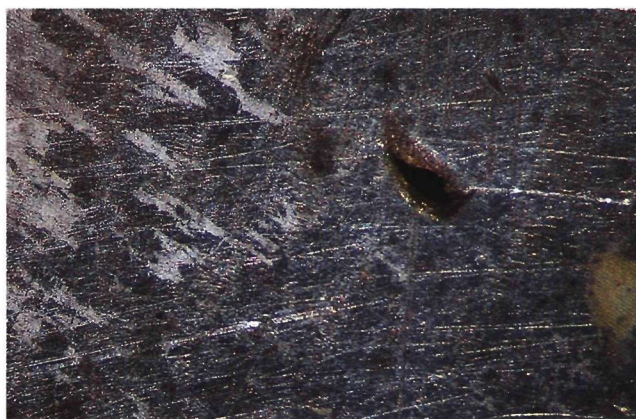
Εικ. 3. Εξωτερική επιφάνεια: τα δύο κεντρικά αποτυπώματα εφαρμογής του μηχανήματος, το ένα πολύ κοντά στο άλλο (το ένα λίγο έκκεντρο, 40x).
