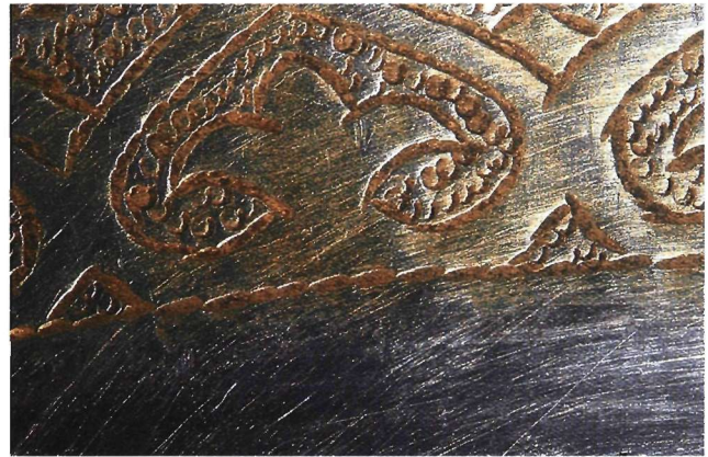
Εικ. 14. Υψίποδο πιάτο αρ. 1 (στεφάνη): Ίχνη από τα εργαλεία κοπής και λιμαρίσματος που έχουν παραμείνει και μετά το στίλβωμα της μεταλλικής επιφάνειας 40x.
