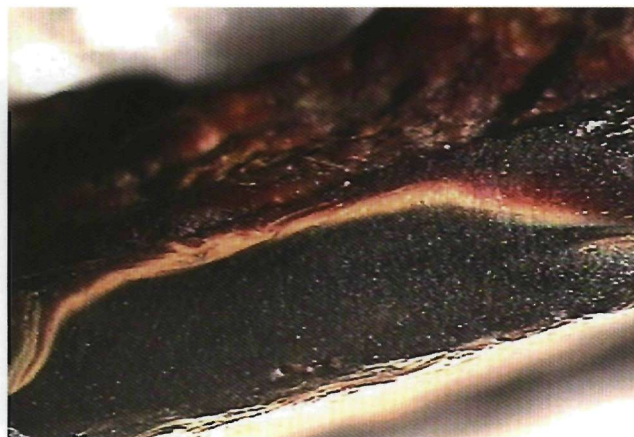
Εικ. 8. Το μέταλλο με αρ. ευρ. 13523. Τα χρωματικά στρώματα κόκκινο φωτεινό, κίτρινο και πράσινο δεν εναλλάσσονται με το σκούρο κόκκινο προς μαύρο. Ξεκινούν από τη μία άκρη ή το μέσο της τομής και καταλήγουν στην άλλη άκρη της (65x).
