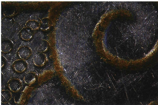
Εικ. 10. Δίσκος αρ. 5: Χρήση εργαλείου, πιθανόν καλεμιού, το οποίο λειτουργεί περισσότερο ως ιχνογράφος αφήνοντας ένα συνεχές κόλλο ίχνος στο πέρασμά του, 25x.
