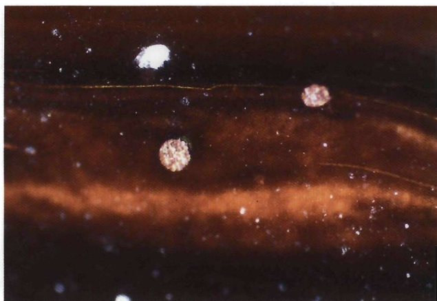
Εικ. 7. Το μέταλλο με αρ. ευρ. 13524. Διακρίνονται τα χρωματικά στρώματα που εναλλάσσονται, όπως μουντό κόκκινο, καφέ και μαύρο (300x).
