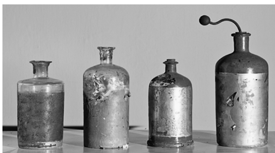
Εικόνα 106. Λουγδουνική φιάλη (Α) και τα τμήματα που την αποτελούν (Β-Δ). 60
