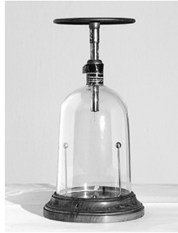
Εικόνα 13β. Ηλεκτροσκόπιο συμπτικνωτικό.
