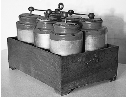
Εικόνα 11α. Η ηλεκτρική συστοιχία της ΜΓΣ.
