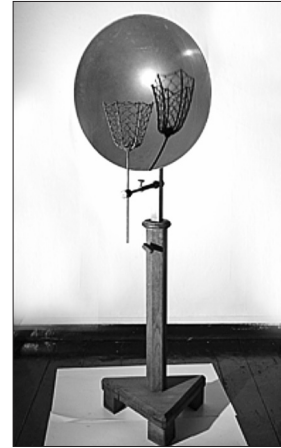
Εικόνα 8β. Το ένα από τα δύο παραβολοειδή κάτοπτρα.
