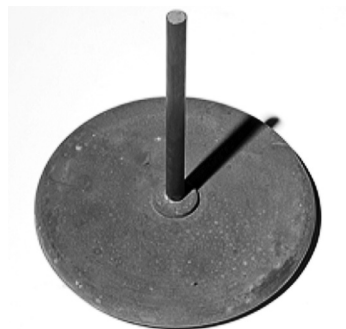
Εικόνα 9β. Δίσκος και λαβή από ηλεκτροφόρο.
