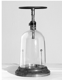
Εικόνα 13β. Ηλεκτροσκόπιο συμπτικνωτικό.
