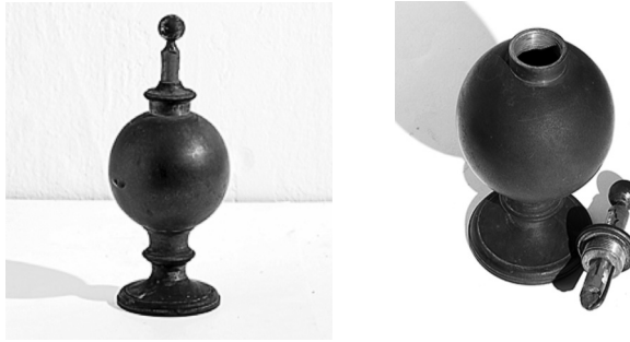
Εικόνα 196. Το σφαιροβόλο της ΜΓΣ. Στη δεξιά φωτογραφία διακρίνεται ο αγωγός με τη μεταλλική σφαίρα στο ένα άκρο του, περιβαλλόμενος από μονωτικό κερί κόκκινου χρώματος.
