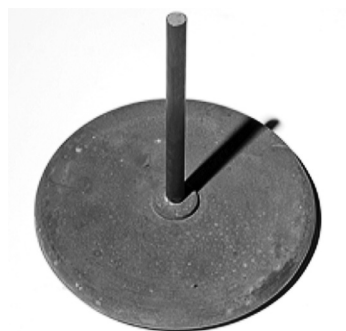
Εικόνα 9β. Δίσκος και λαβή από ηλεκτροφόρο.
