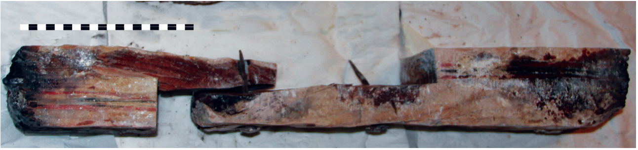
Εικ. 8. Αθήνα, Μεταμόρφωση του Σωτήρα (Σώτεια του Κοττάκη). Βορειοανατολικός κίονας, βόρεια-νότια δοκοθήκη, τεμάχια των ξύλινων ελκυστήρων του ναού.
