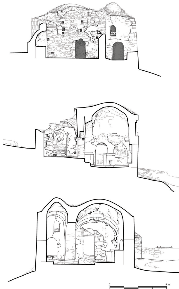
Εικ. 5. Μεσσηνιακή Μάνη, Άι Στράτηγος Καστάνιας. Τομές του μνημείου πριν από τις εργασίες αποκατάστασης: (α) διαμήκης τομή της στοάς προς τα βόρεια (β) εγκάρσια τομή προς τα ανατολικά (γ) τομή κατά πλάτος προς ανατολάς.
