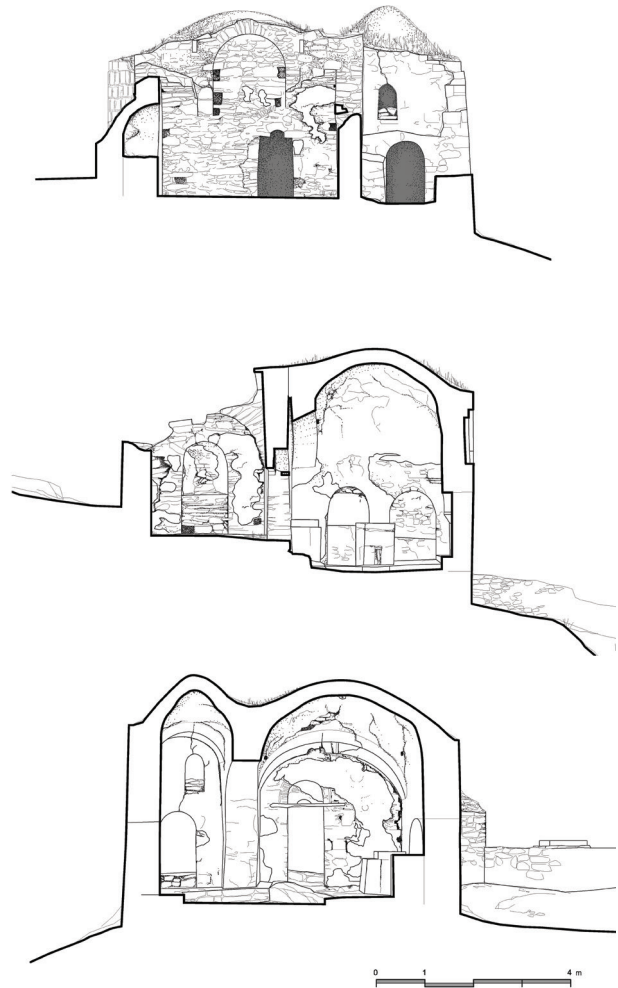
Εικ. 5. Μεσσηνιακή Μάνη, Άι Στράτηγος Καστάνιας. Τομές του μνημείου πριν από τις εργασίες αποκατάστασης: (α) διαμήκης τομή της στοάς προς τα βόρεια (β) εγκάρσια τομή προς τα ανατολικά (γ) τομή κατά πλάτος προς ανατολάς.
