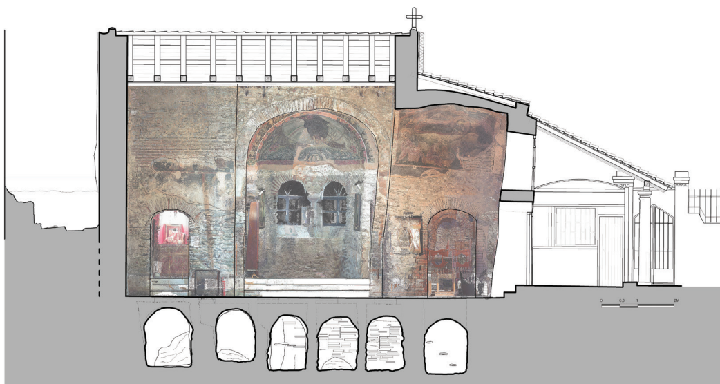
Εικ. 12. Μονή Λατόμου (Όσιος Δανίδ), καθολικό. Τομή Α1-Α1, κατά πλάτος με προβολή προς ανατολικά και ορθοφωτογραφική απόδοση του εσωτερικού.
