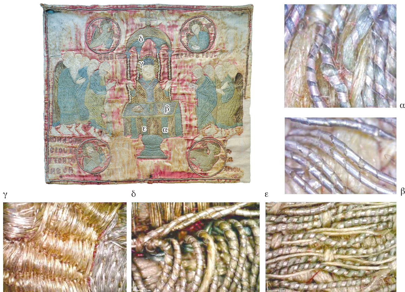
Εικ. 10. Μορφολογικά χαρακτηριστικά νημάτων του αέρα (λεπτομέρειες της Εικ. 1): (α) ελάσματα με ομοιόμορφο πλάτος (από ελασματοποιημένα σύρματα), περιελιγμένα γύρω από πυρήνα με μεταξωτές ίνες, (β) ελάσματα με μεταβαλλόμενο πλάτος (από κομμένα μεταλλικά φύλλα), περιελιγμένα γύρω από πυρήνα με μεταξωτές ίνες, (γ) σύρματα, αργυρά και επιχρυσωμένα, (δ) αραιή και πυκνή περιέλιξη ελάσματος, (ε) συνδυασμός μεταλλικών νημάτων με στριμμένα μεταξωτά νήματα.
