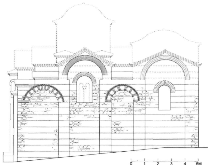
Εικ. 8. Τρίγλεια. Ναός Παντοβασίλισσας. Βόρεια όψη. Αναπαράσταση (σκαρίφημα).
