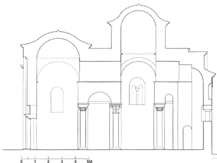
Εικ. 7. Τρίγλεια. Ναός Παντοβασίλισσας. Τομή κατά μήκος. Αναπαράσταση (σκαρίφημα).
