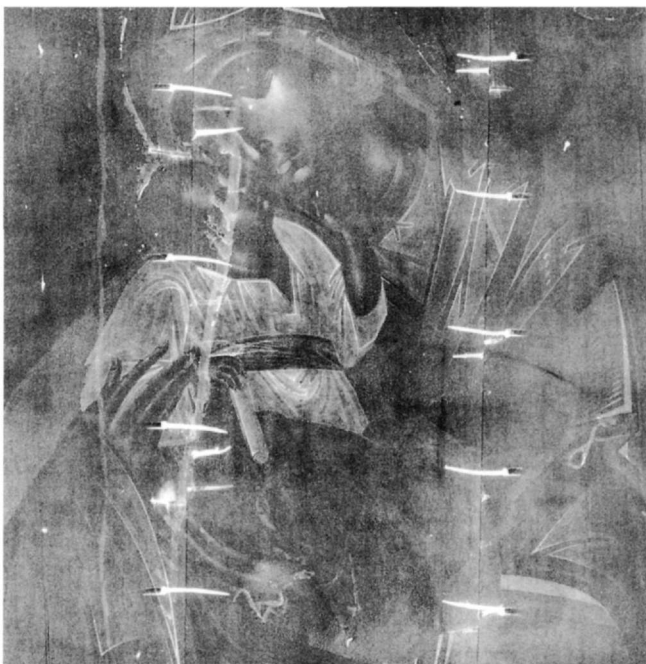
Εικ. 15. Ακτινογραφία της εικόνας της Γλυκοφιλούσας. Διακρίνονται οι συνδέσεις των τριών σανίδων, καθώς και οι σφηνοειδείς βαθύνσεις στο ξύλο.
