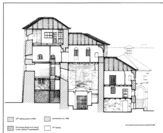
Εικ. 15. Τομή του παρεκκλησίου της Κοιμήσεως της Θεοτόκου και των δίδυμων πύργων της εισόδου (τομή ΓΓ).
