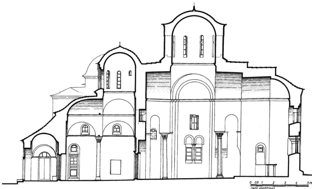
Fig. 5. Section longitudinale (vers le Nord).
