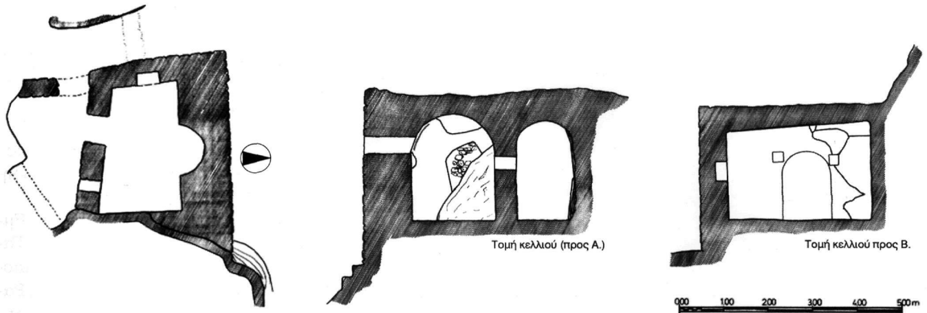
Εικ. 4. Κάτοψη και τομές κτιστού κελλιού.
