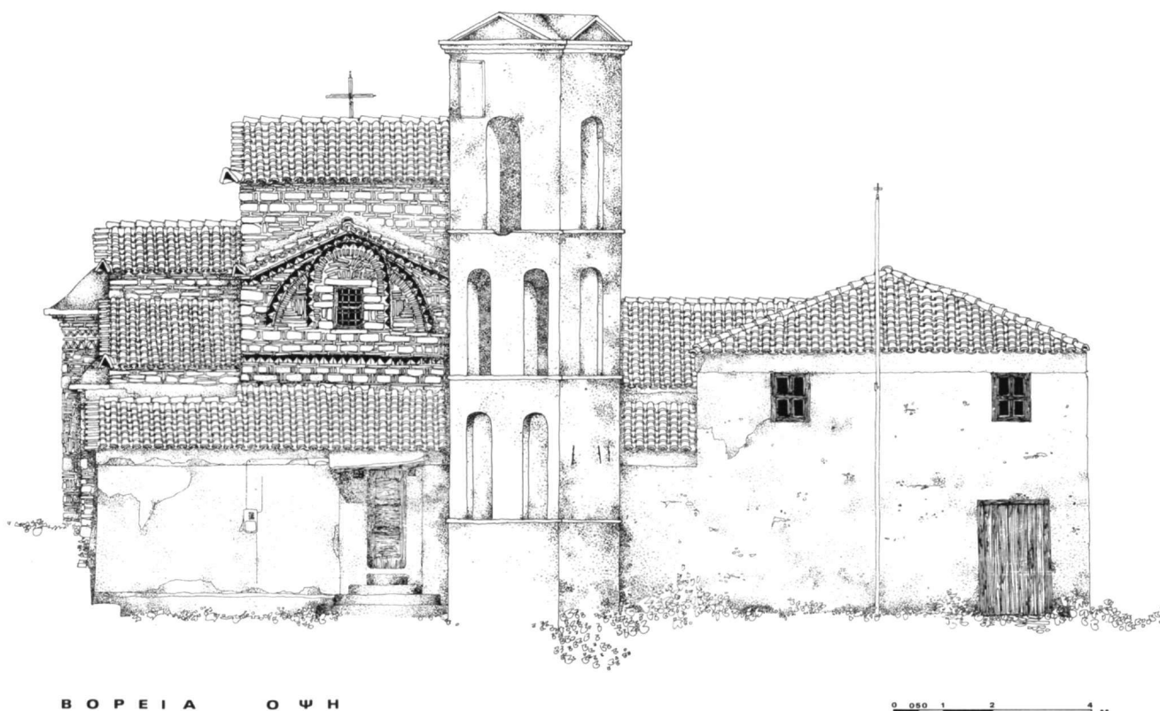
Εικ. 22. Μεγάλη Παναγιά. Βόρεια όψη του ναού (υπάρχουσα κατάσταση).
