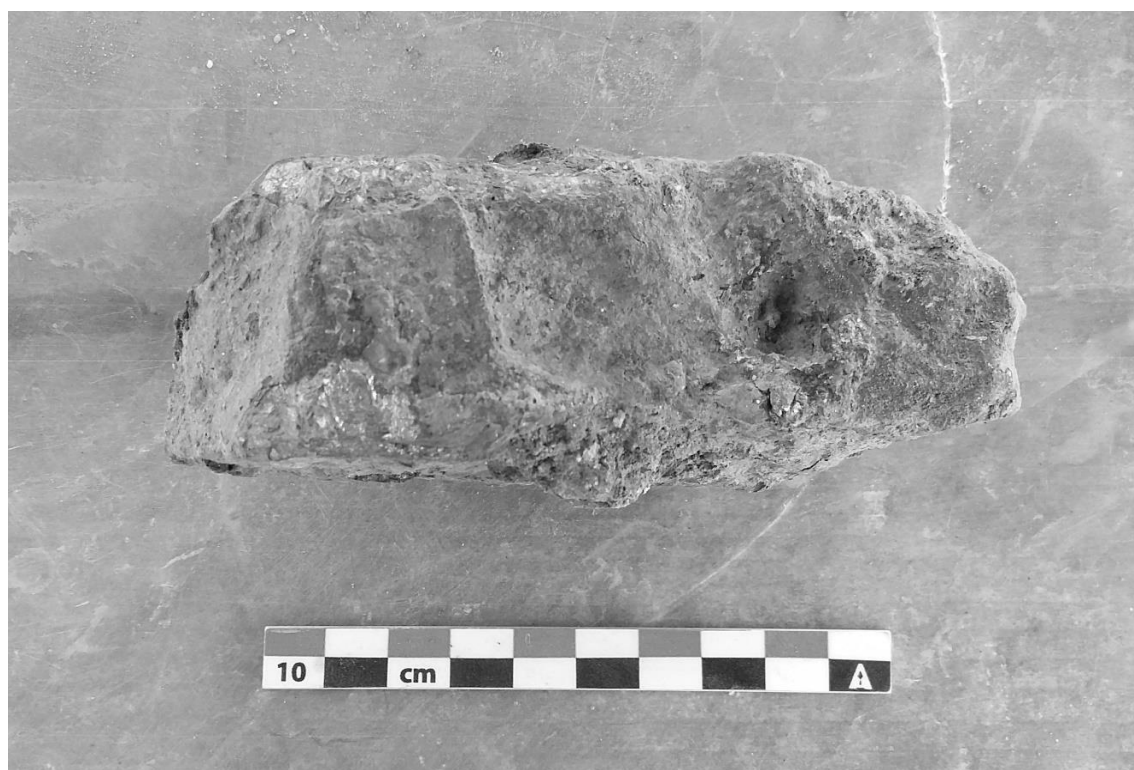
Εικόνα 11. Θραύσμα μεταλλουργικού απορρίμματος τύπου spreiss-αρσενίδια σιδήρου (φωτ. Ν. Νεραντζής).
