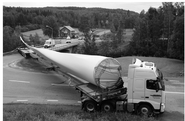
Εικόνα 8. Μεταφορά τμήματος ανεμογεννήτριας όχημα βαρέως τύπου
