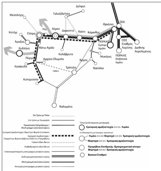
Διάγραμμα 2. Διάγραμμα του βασικού κορμού σιδηροδρομικής και οδικής σύνδεσης στην Πελοπόννησο με αναγνώριση της ισχυρής κομβικότητας ως προς τον προγραμματισμό συνδυασμένων μεταφορών και λειτουργιών, πηγή εικόνας: ©iocarydi.com, ίδια επεξεργασία.
