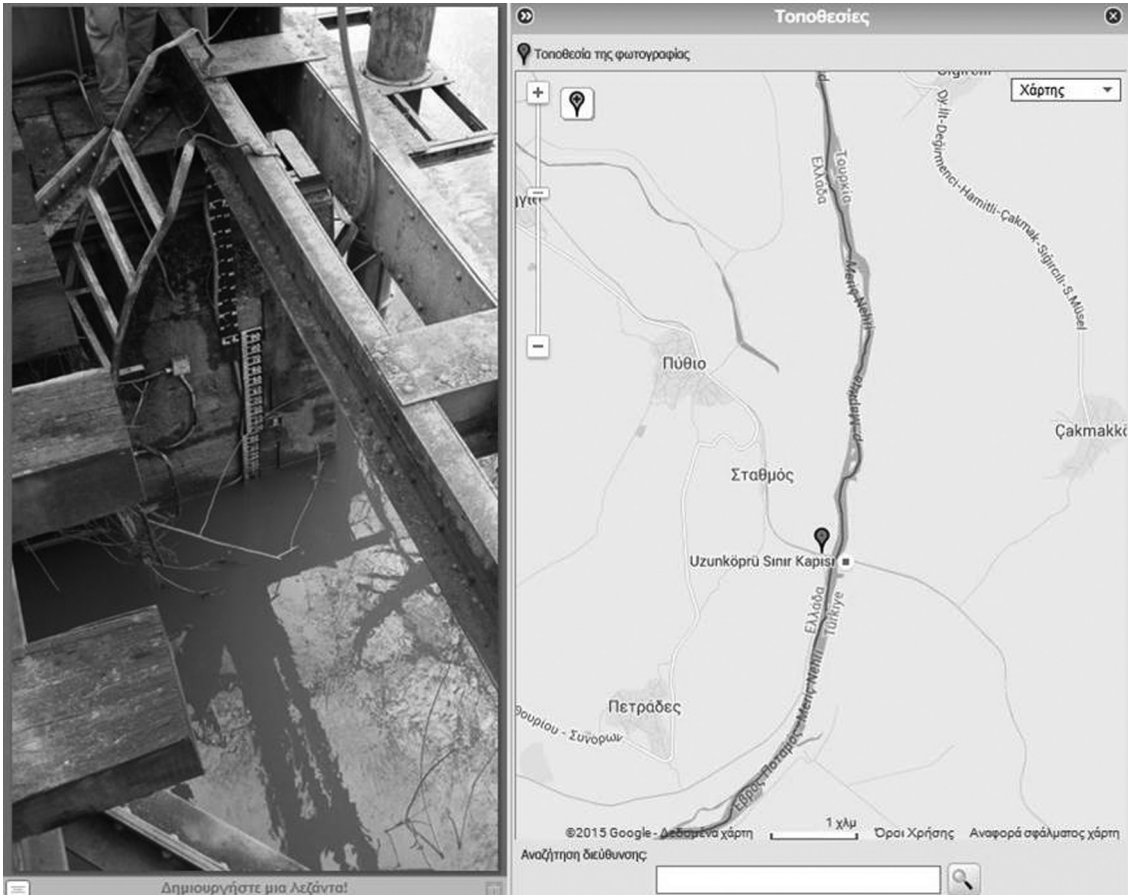
Εικόνα 4ε Οπτικά σταδία για μέτρηση στάθμης, Πηγή Δνση Πολιτικής Προστασίας ΠΑΜΘ
