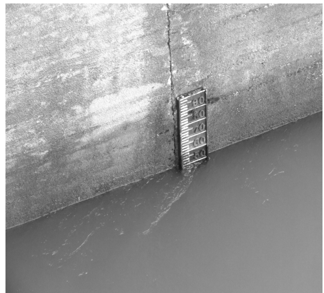
Εικόνα 4δ, Σταδία στα βάθρα γέφυρας, Πηγή Δνση Πολιτικής Προστασίας ΠΑΜΘ
