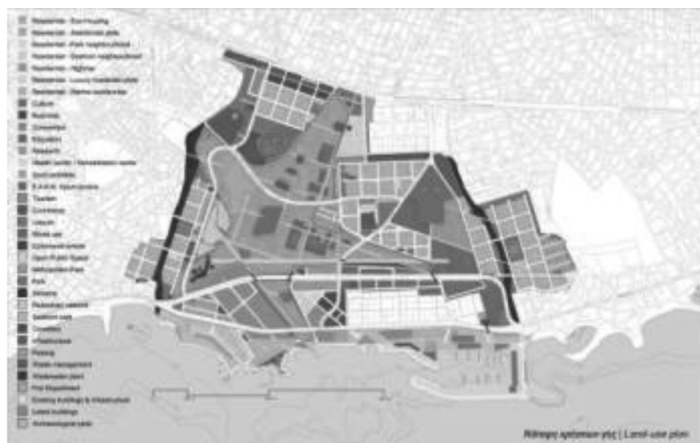
Εικ.10: Κάτοψη χρήσεων γης (land-use plan) της μελέτης «Hellinikon – Spyros Pollalis». Διακρίνεται η ζώνη πρασίνου σε σχήμα αστεριού (εξού και το όνομα της μελέτης «Πράσινος Αστερίας»), οι ζώνες οικιστικής ανάπτυξης (πέντε συνολικά), του εμπορίου και αναψυχής (παραλιακό μέτωπο, Λεωφόρος Βουλιαγμένης και κεντρικός άξονας διαμόρφωσης παράλληλα προς Λεωφόρο Ποσειδώνος), εκπαίδευσης/έρευνας και πολιτισμού (κεντρικά και β/α) και τέλος το ΕΑΚΝ Αγίου Κοσμά στο κέντρο του «Αστερία».
