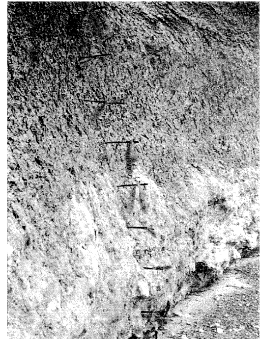
Εικόνα 2. Οριζόντια καρφιά μήκους 1,5 μ. σε κατακόρυφο προάνες κροκαλοπαγών της παραλίας Εσοχής (Ροδόπη) για τη μέτρηση της υποχώρησης της ακτής
