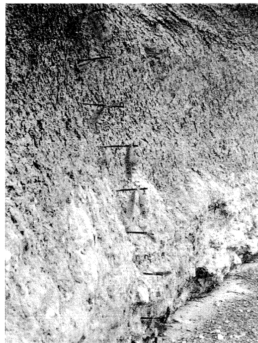
Εικόνα 2. Οριζόντια καρφιά μήκους 1,5 μ. σε κατακόρυφο προάνες κροκαλοπαγών της παραλίας Εσοχής (Ροδόπη) για τη μέτρηση της υποχώρησης της ακτής
