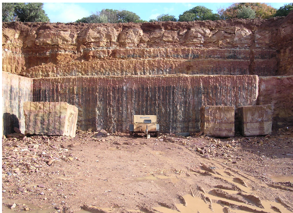
Fig. 2. Quarrying front showing the four commercial types of the Thymianá Stone. Εικ. 2. Μέτωπο εξόρυξης με τους διάφορους εμπορικούς τύπους της «Πέτρας Θυμιανών».
