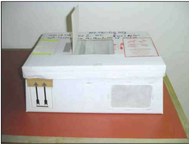
Εικόνα 1. Κλειστός κλωβός μεταφοράς τρωκτικών με εμφανές το παράθυρο παρατήρησης στο άνω τμήμα και μία από τις θυρίδες αερισμού με φίλτρο στο πλαϊνό τοίχωμα.
