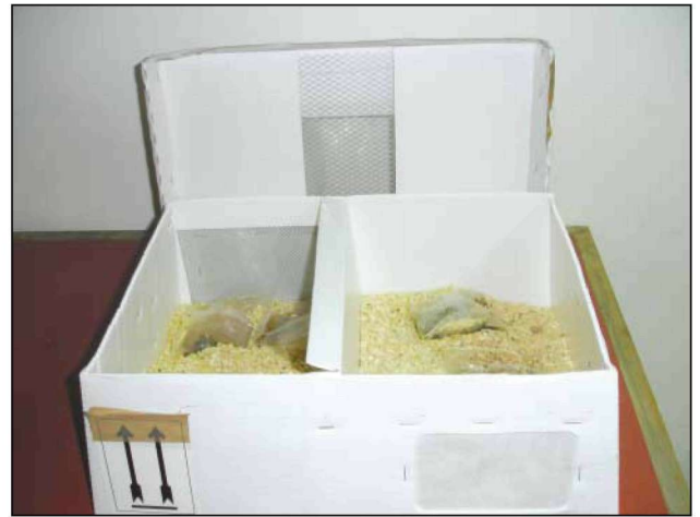
Εικόνα 2. Ανοιχτός κλωβός μεταφοράς τρωκτικών, όπου διακρίνονται το εσωτερικό χώρισμα, το προστατευτικό πλέγμα του παράθυρου παρατήρησης και τον φίλτρο αερισμού του πίσω πλαϊνού τοιχώματος, η στρωμένη δαπέδον με πριονίδι και οι πλαστικές πηγές ενυδάτωσης για τρωκτικά.
