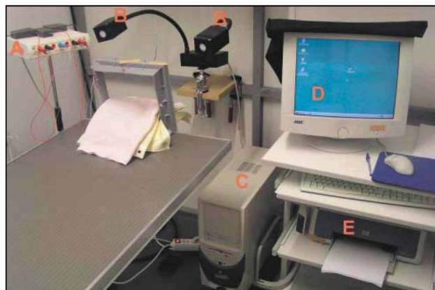
Εικόνα 7. Σύγχρονη συσκευή συλλογής ΗΑΓμάτων. Α: Ηλεκτρόδια, Β: Φωτοερεθιστές, C: Κεντρική μονάδα ηλεκτρονικού υπολογιστή, D: Οθόνη παρακολούθησης της εξέτασης και ανάδειξης-διαχείρισης των γραφημάτων, E: Συσκευή εκτύπωσης των γραφημάτων.
