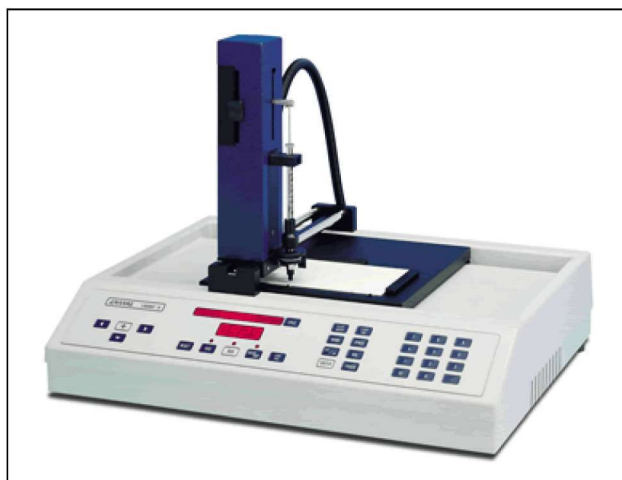
Εικόνα 3. Συσσκευή αυτόματης ενστάλαξης της πλάκας HPTLC. Figure 3. Apparatus for automatic spotting of the HPTLC plate.
