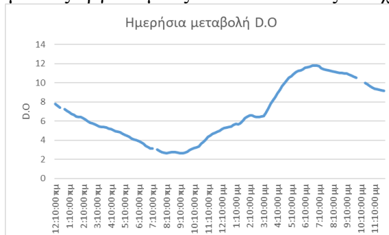
Σχ. 4. Κατά τις απογευματινές ώρες καταγράφονται οι μεγαλύτερες τιμές διαλυμένου οξυγόνου στο νερό λόγω της διαδικασίας φωτοσύνθεσης των υδρόβιων φυτών. Λίμνη Κοιμουνδούρου, 30/07/2015 (ΕΛΚΕΘΕ)
