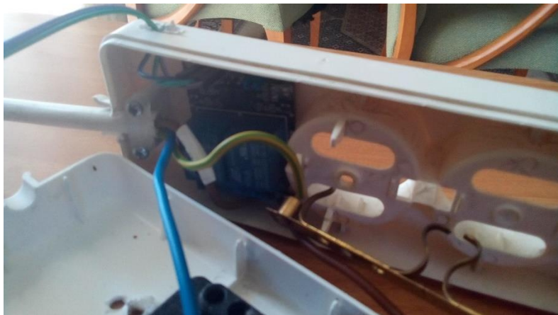
Εικόνα 5: Σύνδεση του ρελέ με το πολύπριζο
