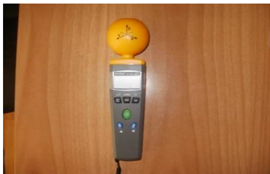
Σχήμα 4: Ισοτροπικός αισθητήρας M480836 Extech Instruments
