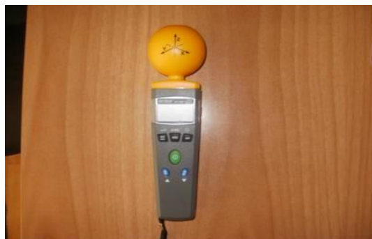
Σχήμα 4: Ισοτροπικός αισθητήρας M480836 Extech Instruments
