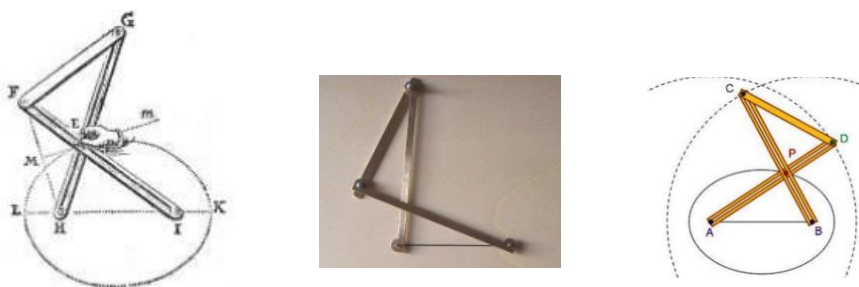
Σχήμα 8: Αναπαραστάσεις μοντέλου ελλειψογράφου του Frans van Schooten
