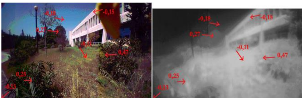
Σχήματα 11 & 12: Τιμές NDVI για διαφορετικά είδη βλάστησης, ανέφελο ουρανό και κτήριο.
