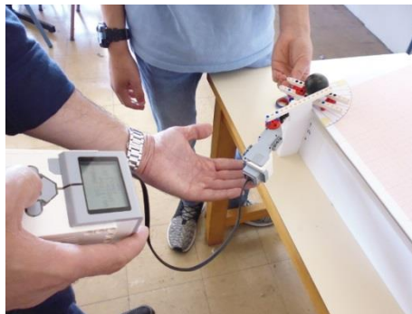
Σχήμα 1: Μηχανική κατασκευή για βολές με ελεγχόμενη αρχική ταχύτητα
