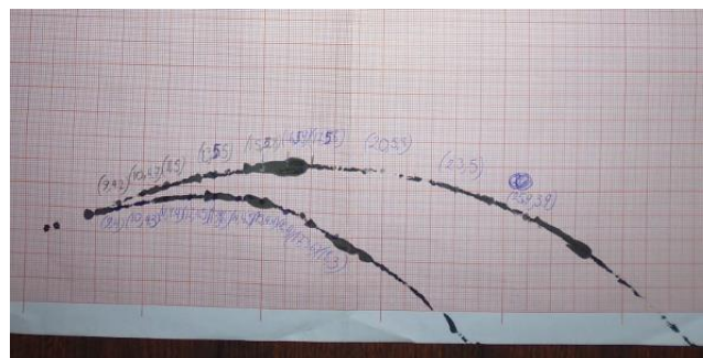
Σχήμα 4: Δύο τροχιές με την ίδια γωνία βολής αλλά διαφορετικές αρχικές ταχύτητες
