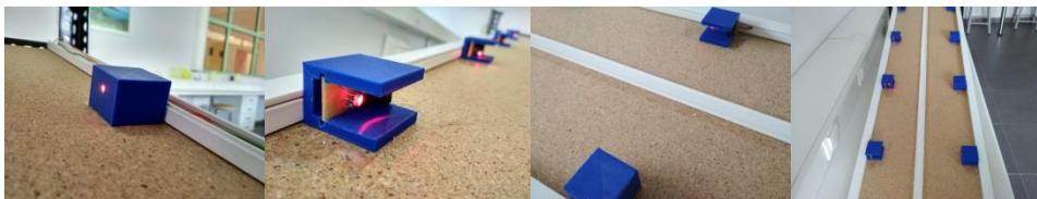
Εικόνα 3 Οι φωτοπύλες και οι βάσεις τους στο κεκλιμένο επίπεδο
