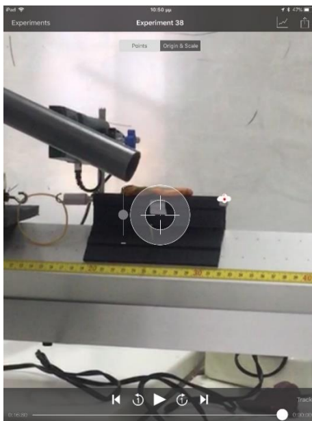
Εικόνα 1: Πειραματική διάταξη με ιπέα αεροτροχιά προσαρμοσμένο ελατήριο με συνδεδεμένο αισθητήρα δύναμης. Η σφαίρα προσπίπτει από τον προσαρμοσμένο σωλήνα, ενώ η θέση του ιπέα καταγράφεται και αναλύεται από tracker.
