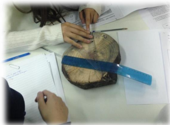
Σχήμα 3: Μέτρηση εύρους δακτυλίων
