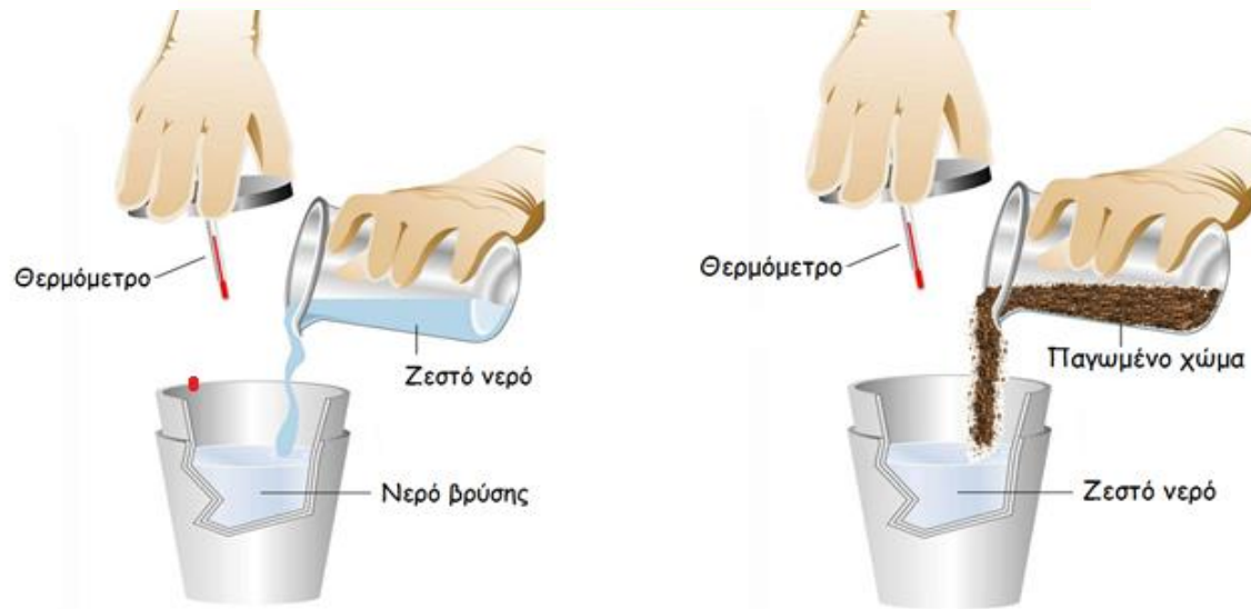
Σχήμα 2: Πειραματική διαδικασία για τον υπολογισμό της θερμοχωρητικότητας θερμοδομέτρου και της ειδικής θερμότητας εδάφους
