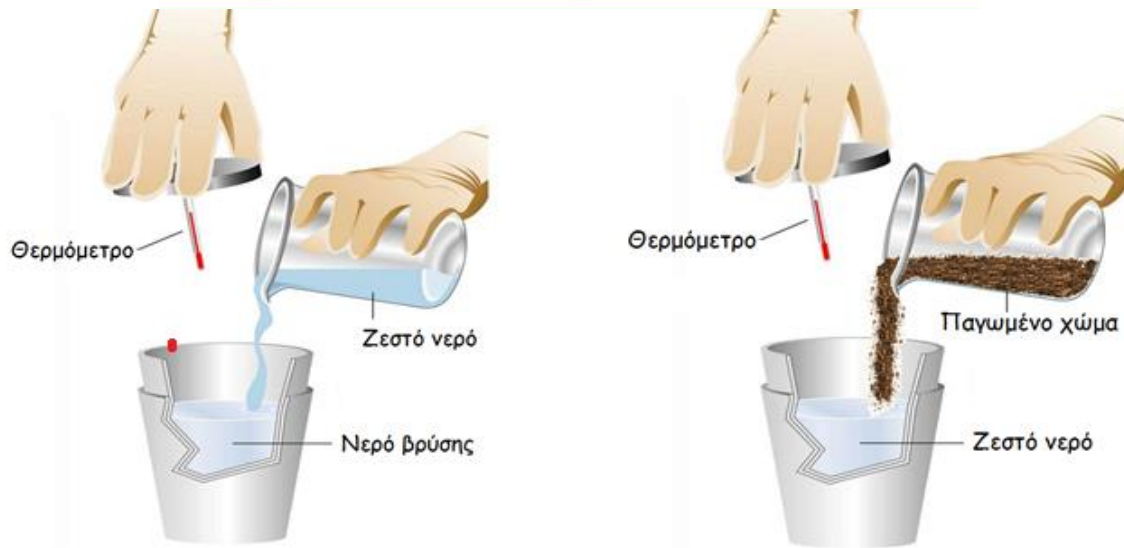
Σχήμα 2: Πειραματική διαδικασία για τον υπολογισμό της θερμοχωρητικότητας θερμιδομέτρου και της ειδικής θερμότητας εδάφους
