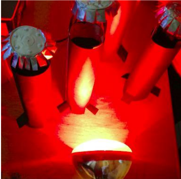
Εικόνα 2: Παρατηρούμε πώς ο ζεστός αέρας ανεβαίνει προς τα πάνω με μια απλή κατασκευή.
