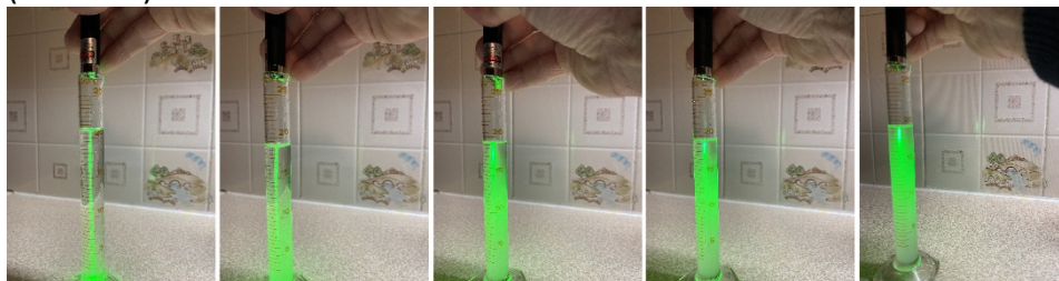
Εικόνα 3: Σταδιακή θόλωση του διαλύματος και μείωση της διείσδυσης της δέσμης φωτός στο διάλυμα.
