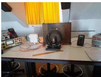
Σχήμα 1: Διάταξη συσκευών, των πηνίων Helmholtz και της λυχνίας.
