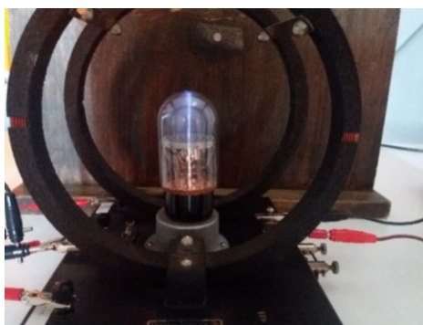
Σχήμα 2: Η δέσμη ηλεκτρονίων όταν δεν παρέχεται ηλεκτρικό ρεύμα
