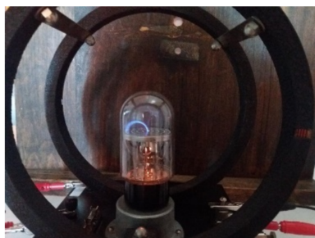
Σχήμα 2: Η δέσμη ηλεκτρονίων όταν δεν παρέχεται ηλεκτρικό ρεύμα
