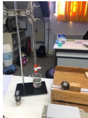
Σχήμα 1α: Στην εικόνα αριστερά φαίνεται η στήλη με το νερό, ενώ δεξιά φαίνεται το κεκλιμένο επίπεδο στο οποίο κινήθηκαν οι σφαίρες σε όλες τις μεθόδους.
