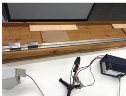
Σχήμα 1β: Στην αριστερή εικόνα φαίνεται το κεκλιμένο και η φωτοπύλη. Στην δεξιά εικόνα φαίνεται το χρονόμετρο που χρησιμοποιήθηκε για τις μετρήσεις.
