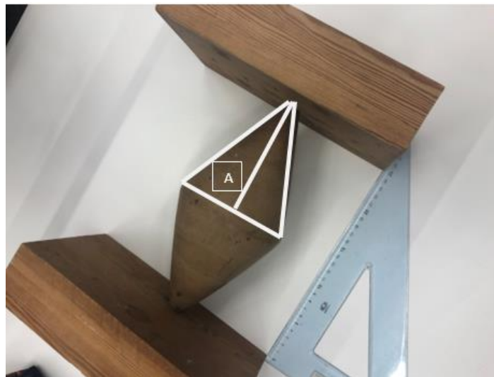
Σχήμα 4: Η μέτρηση της γωνίας 2\gamma
