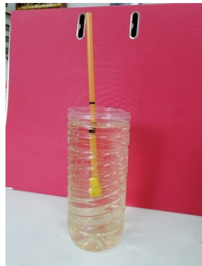
Σχήματα 10-11: Το βαθμονομημένο πυκνόμετρο βυθίζεται σε μύρα και κρασί.
