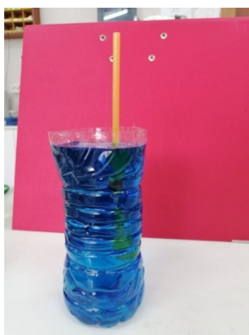
Σχήματα 5,6,7:Βαθμονόμηση του πυκνομέτρου με τα υγρά αναφοράς.
