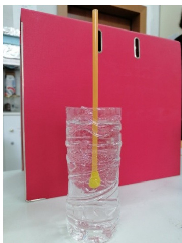
Σχήματα 5,6,7:Βαθμονόμηση του πυκνομέτρου με τα υγρά αναφοράς.
