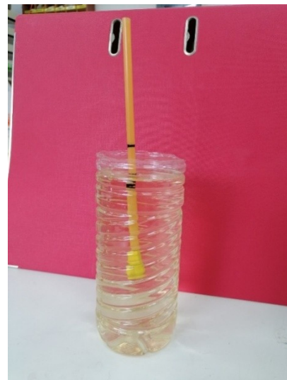
Σχήματα 10-11: Το βαθμονομημένο πυκνόμετρο βυθίζεται σε μύρα και κρασί.
