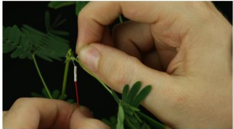
Εικόνα 4: Σύνδεση του ηλεκτροδίου στον βλαστό της μιμόζας.
