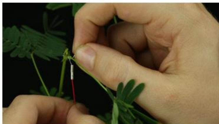
Εικόνα 4: Σύνδεση του ηλεκτροδίου στον βλαστό της μιμόζας.
