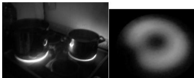
Σχήματα 8 & 9: Ηλεκτρικές εστίες που ακτινοβολούν υπέρυθρη ακτινοβολία σε απόλυτο σκοτάδι.
