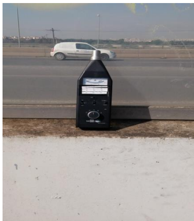
Εικόνα 7. Το ηχόμετρο την ώρα των μετρήσεων
