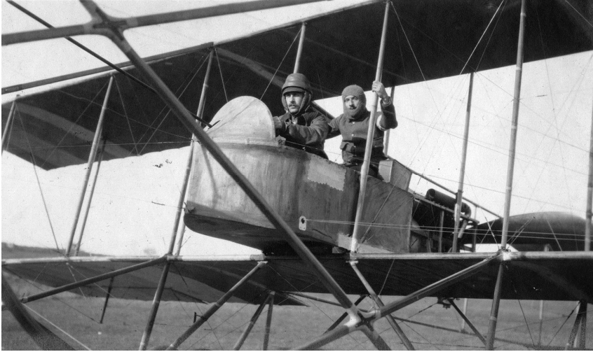
ΕΙΚΟΝΑ 7: Στο αεροδρόμιο της Νικόπολης. Πιλότος (πιθανώς ο υπολοχαγός Μ. Μουτούσης) και συνεπιβάτης στο πιλοτήριο διπλάνου MF-7 Longhorn με κινητήρα Renault 80 h.p. V8. Στα φτερά διακρίνονται τα φατνώματα από λευκές και γαλάζιες ταινίες, χαρακτηριστικές των ελληνικών αεροπλάνων. Φωτογραφία του Etienne Labranche, Δεκέμβριος 1912 (Φωτογραφικό Αρχείο Ιδρύματος Ακτία Νικόπολις, IAN F2333)
